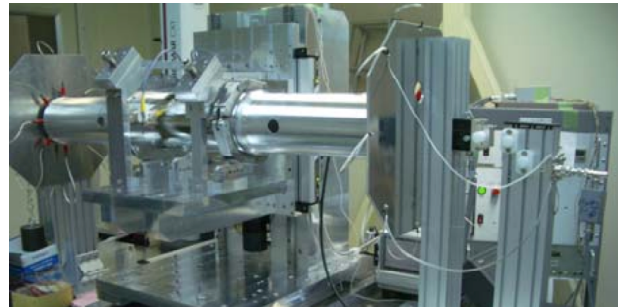
図 55 : BPM のワイヤー校正のセットアップ。
