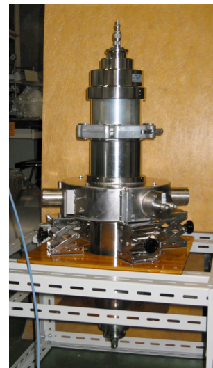
図 51 : 同軸変換器による WCM ベンチ校正。
